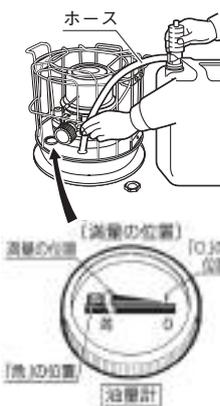
お願い ●オート給油ポンプを固定する場合は、ホースを油タンクにクリップで固定できないので、必ず、ホースが給油口から抜けないように手で固定しながら使用してください。
